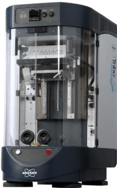
La versatilité des instruments permet de programmer les conditions décrites par les normes pour appliquer un protocole donné que ce soit du point de vue mécanique et environnemental, comme le frottement, la température, la vitesse de glissement et les conditions de vibration.
